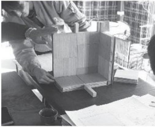
90cm×90cmのパネルを中心に各種サイズの木製パネルと、そのほかのパーツを組み合わせて接合することで、専門的な知識や技術がなくても、自分の思いのままにオリジナルな空間を実現させることが可能。パネルは、耐震性、気密性、断熱性、防音性、防水性を確保しているので、その
