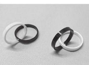
ジルコニアセラミックスは、弾力性が有るためリングに切り込みを入れると、写真のような組み込みができる
